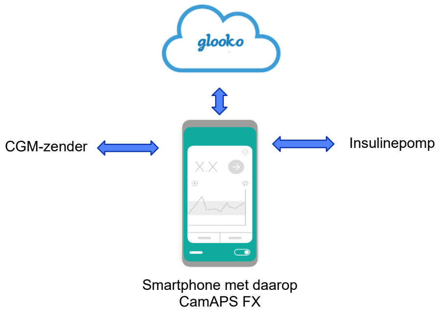
Afbeelding 2: Voorbeeld van een configuratie van het closed-loop-systeem waarbij de CamAPS FX-app op een Android-smartphone staat.
